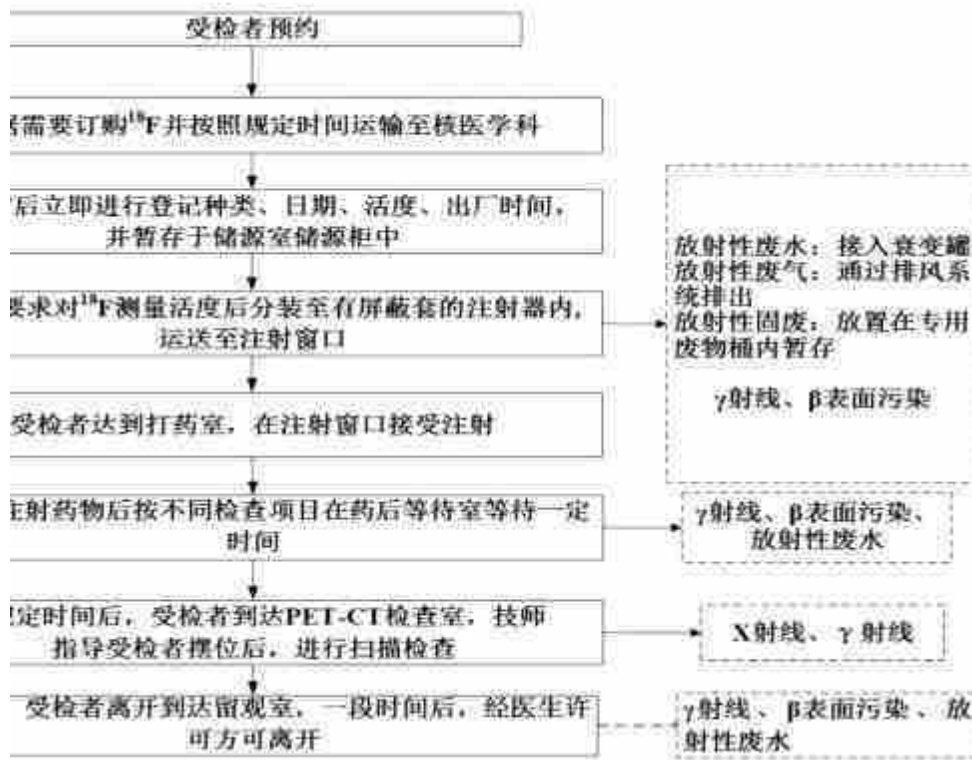
图 2-2 PET-CT 诊断流程及排污节点图
